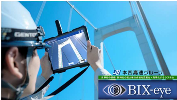
主塔のカメラ映像とBIMモデルの重ね合わせ
