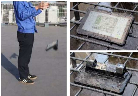
〈耐環境性能実験(左:1.2m高からの落下実験 右:耐水実験)〉
