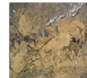
風化が進行, 岩塊の強度の低下が顕著, 粘板岩
