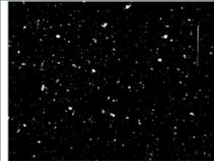
図-1) コンクリート表層を健全部(黒)と気泡発生部(白)に二値化処理
