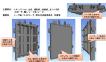
【機械設備（ローラーゲート）】
