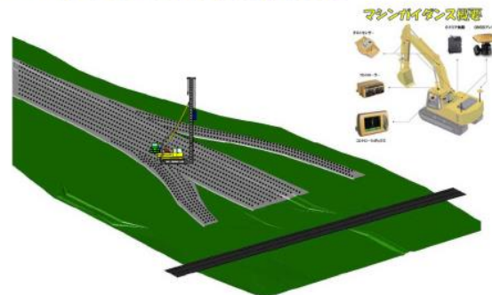
ペーパーレーン位置出しをマシンガイダンスで管理
