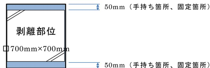
図— 1 試験板の寸法・形状（□700mm×800mm t=3.2mm（約 14kg））
