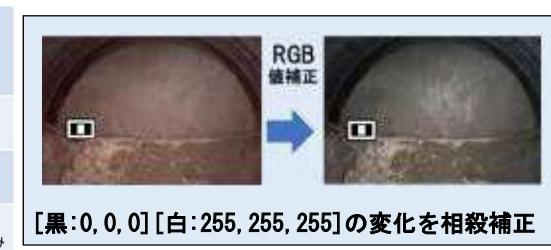
図-4 色見本を用いた補正の例
