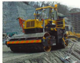
③振動ローラー 鉄輪ローラーを振動させながら締めます。
