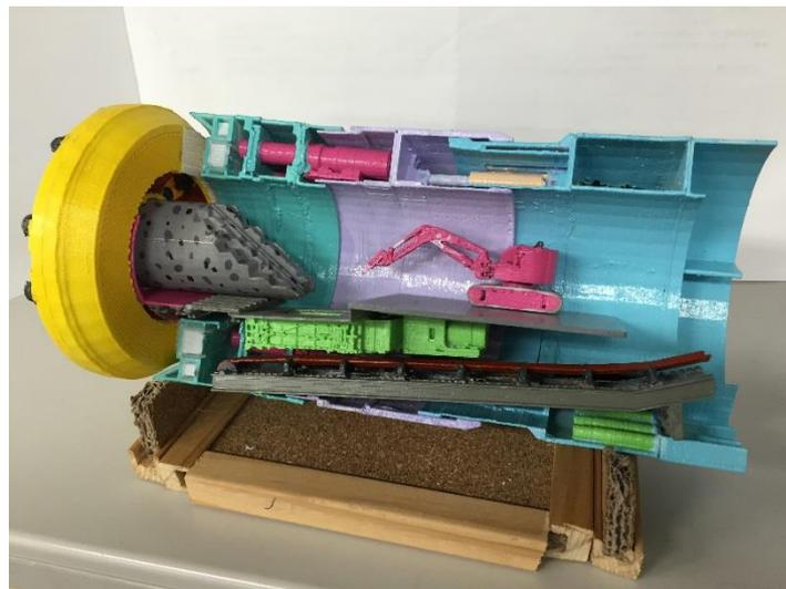
出力した3Dモデル(φ6mDTBMマシン 縮尺1:50)
