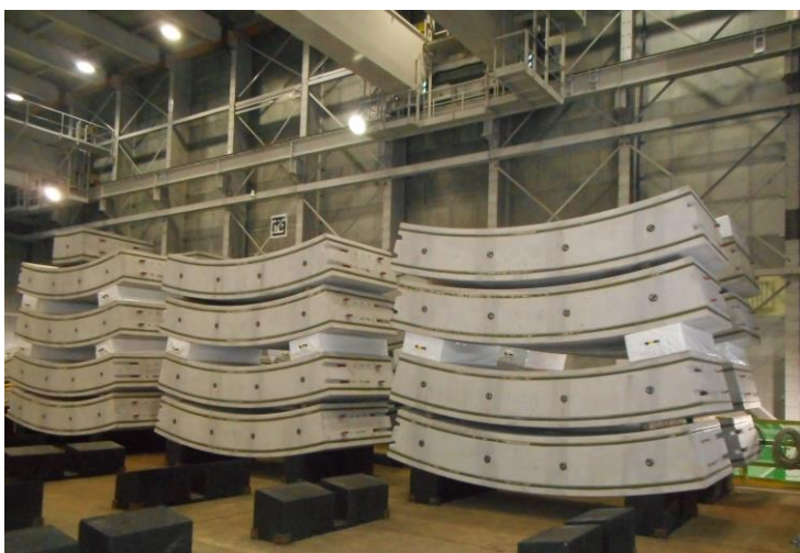
セグメント仮置き状況
